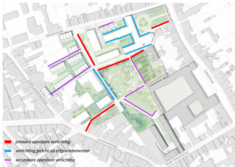
Implanting verlichting site
