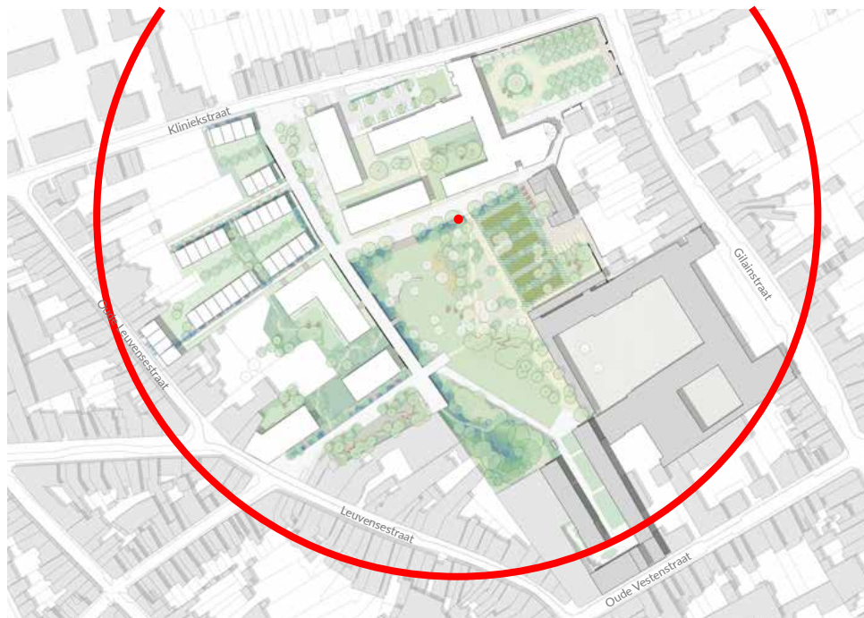
Hydrant met straal van 200 meter
