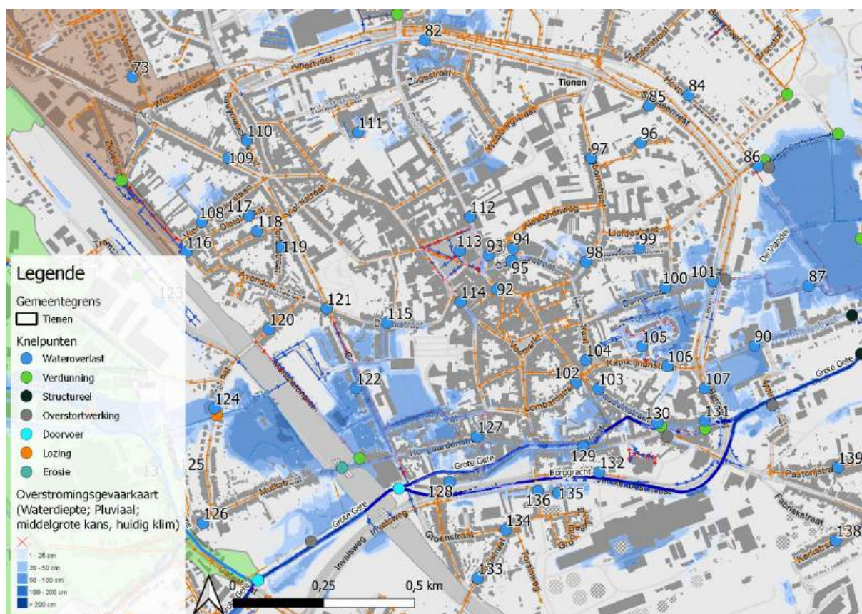
Figuur 85: Overzicht van de geïnventariseerde knelpunten in deelzone Grote Gete (stadscentrum Tienen).
